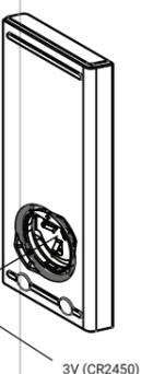
Tournez le couvercle de la batterie à l'aide de la pièce de monnaie ou de l'outil fourni dans le socle, pour le déverrouiller et replacez le côté négatif de la batterie vers le haut.
