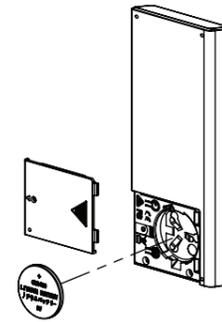
Posizionare una batteria CR2430 con il lato positivo (+) rivolto verso l'alto.
