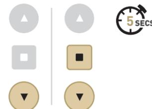
Portare la tenda nella posizione di fincorsa inferiore desiderata premendo ripetutamente la freccia discesa. Successivamente tenere premuti contemporaneamente discesa e stop per 5 secondi per registrare il fincorsa.
