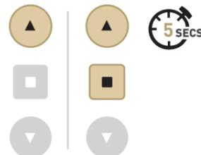
Portare la tenda nella posizione di fincorsa superiore desiderata premendo ripetutamente la freccia salita. Successivamente tenere premuti contemporaneamente salita e stop per 5 secondi per registrare il fincorsa.
